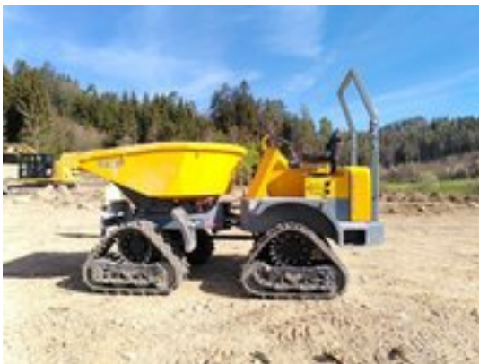
Einsatz von Raupendumper für den Transport des Waldbodens zum Depots sind angelegt, Abnahme der fertigen Zwischenlager durch Bauleitung und Bauherrschaft.
