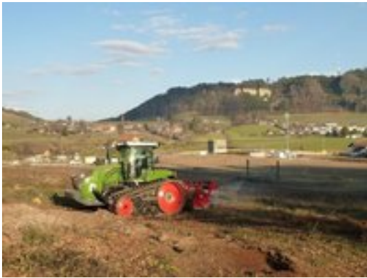
Stockfräse auf Raupen zur bodenschonenden Arbeitsausführung
