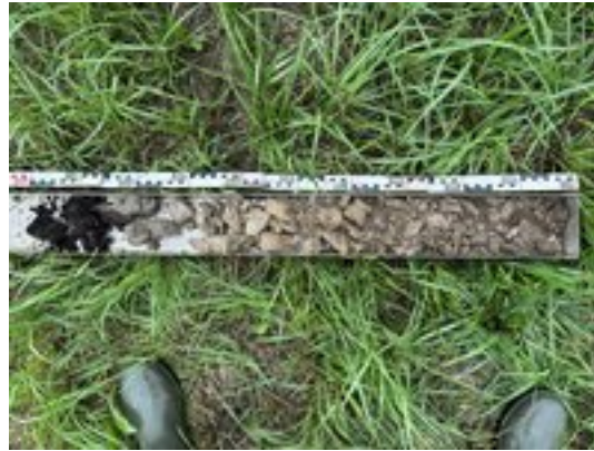
Handbohrung, Bodenaufbau mit Torfschicht (dunkel). Zeigt den ursprünglich höheren Grundwasserstand.
