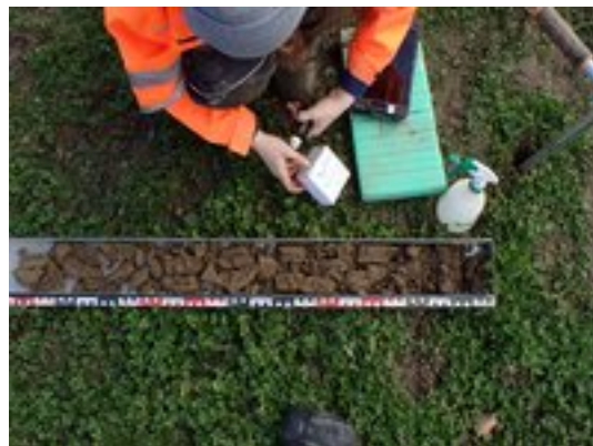
pH, Kalkgehalt, Körnung und weiteres wird direkt im Feld bestimmt.
