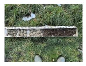
Handbohrung, Bodenaufbau mit Seekreide (weiss).
