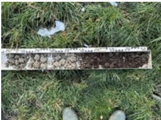
Handbohrung, Bodenaufbau mit Seekreide (weiss).
