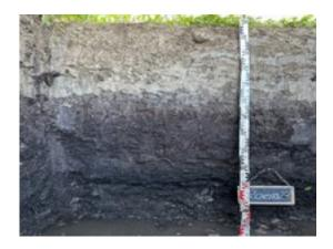
Leitprofil Bodentyp Buntgley mit Torfschicht.
